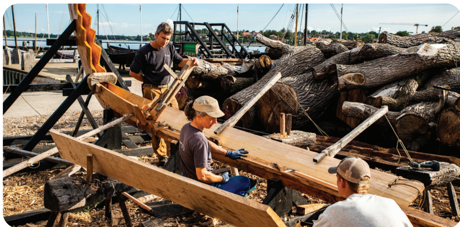
Skibets nederste bordgang (langsgående plankerækker) blev færdig sidste år. Foto: Werner Karrasch
